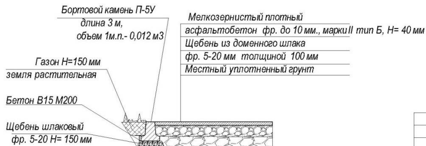
Схема 3 Конструкция покрытия тротуара Примыкание к газону
